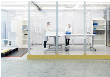
Bild 2: Schinko-Press-Reinraum-2021.jpg Aus einem Montageplatz für Reinraumteile wurde eine 24 Quadratmeter große Reinraumzelle nach DIN EN ISO 14644-1. © Jürgen Grünwald, Abdruck honorarfrei
