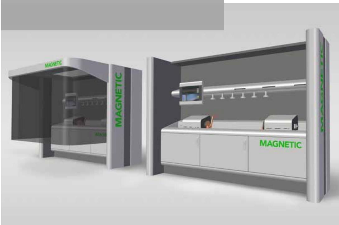
Die Rissprüfanlage verfügt über ein hochpräzises Magnetic Particle Inspection System, einen Blendschutz und eine integrierte Entlüftung, die für Umweltschutz sorgt. Die Prüfteile werden mittels Palette unterhalb durch den Schutzvorhang ergonomisch der Anlage zugeführt. Große und schwere Teile können der Prüfanlage mittels Kran von oben durch ein Schiebedach in Position gebracht werden.
