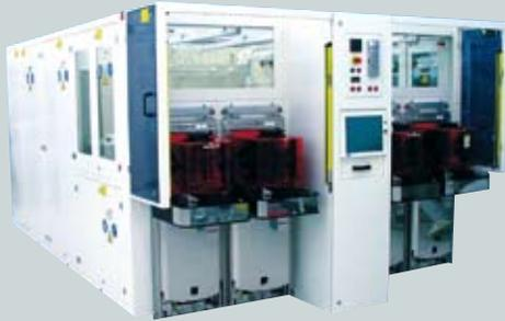
**MASCHINENVERKLEIDUNG FÜR DIE HALBLEITER-INDUSTRIE:** Ausführung in pulverbeschichtetem Niro in Kombination mit Sonderkunststoffverglasung. Schinko übernimmt den Teilzusammenbau und realisiert Sonderwünsche nach Reinraumstandards samt EMV-Schutz.
